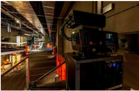
Les projecteurs laser permettent d'économiser jusqu'à 40 % d'énergie par rapport aux projecteurs à lampes au xénon.
